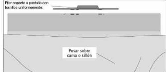
Poner el televisor boca abajo apoyando la parte de la pantalla en la cama o sillón para que no se raye.
