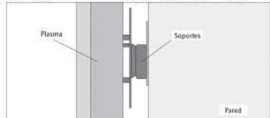
Llevar el plasma o LCD con su soporte instalado a la otra pieza que ya está fija al muro. Enganchar ambas piezas hasta que la pantalla quede muy firme.
